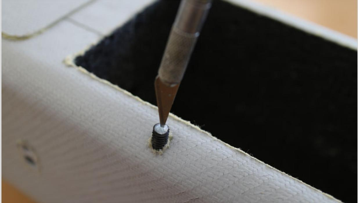
*An X-Acto blade removes a broken wing bolt.*
